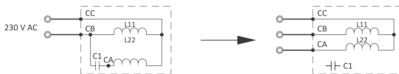
Typisches Diagramm eines Einphasenmotors mit Anlaufkondensator
